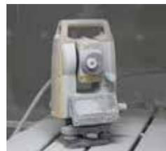
在基线上对仪器的测距精度进行检测,在检定台上对仪器的整平性能和测角精度进行检测,以确保您对 GM-52 系列产品质量满意。
