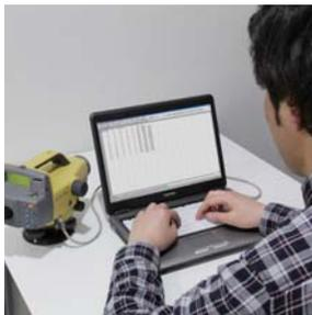
DL-502/503可以存储多达2000组的观测数据。数据可以用随机配套的“DL-502/503 TOOL数据运输软件”以CSV格式下载到计算机中。
